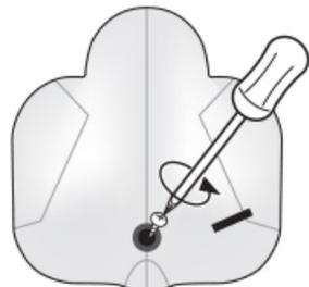
1. Localize o compartimento de baterias nas costas do boneco. Com uma ferramenta apropriada, remova o parafuso e retire a tampa.
