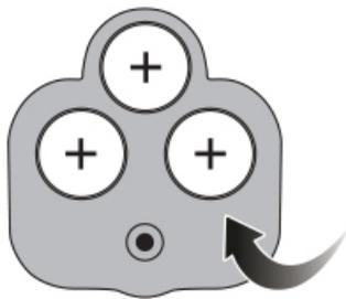
2. Retire as baterias antigas e descarte-as em local apropriado. Após isso, insira 3 novas baterias LR44 respeitando as polaridades.
